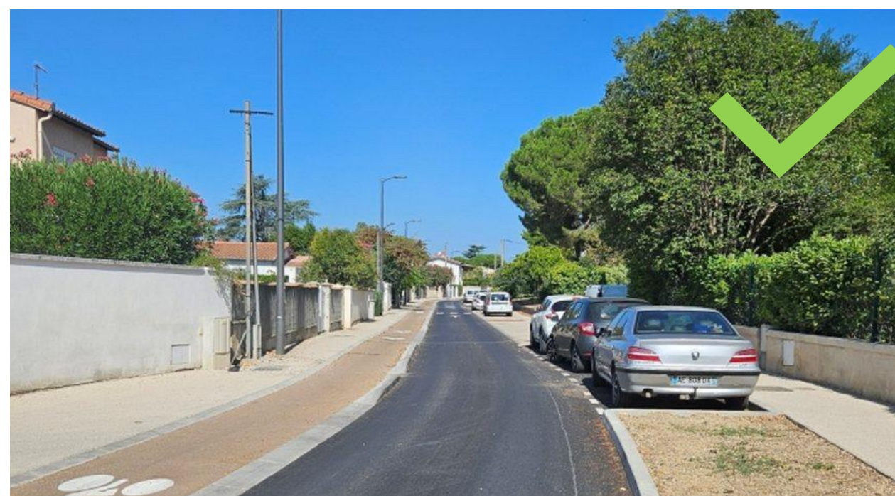
Contre-sens cyclable en piste avec un enrobé de couleur différente, à Castelnau-le-Lez (34)
